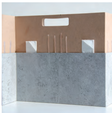
▲ Montage mit Silikon & Schaumstoffklebeband
